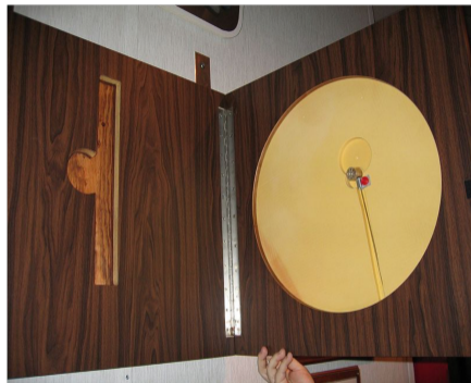
Abb. 7: Das Siegel enthielt eine Metallkonstruktion, die bei entsprechender Funkbestrahlung den Strahl moduliert und das Abhören des Raumes ermöglichte. © Rechte siehe Anhang.
