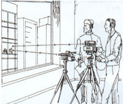
Abb. 8: Die Reflexion des Laserstrahls wird durch die Vibrationen der Scheibe moduliert.
