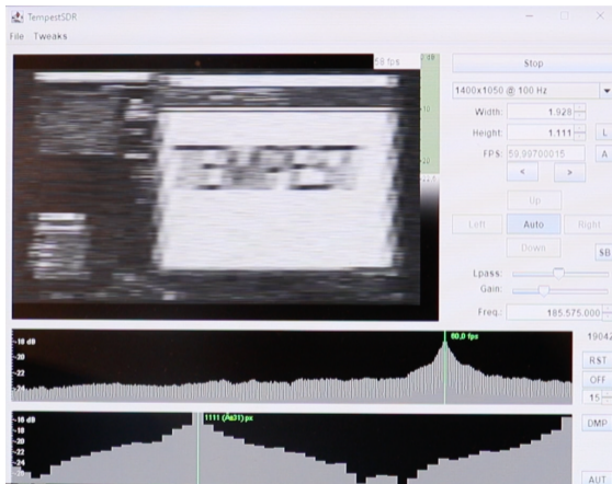
Abb. 4: Tempest-Angriff: Aus den elektromagnetischen Abstrahlungen eines Monitors kann der Bildschirminhalt rekonstruiert werden. © Rechte siehe Anhang.
