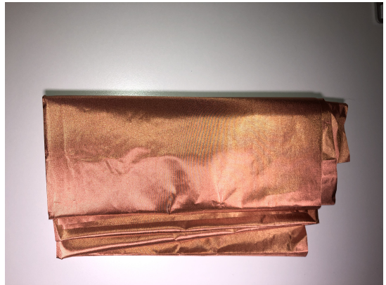
Abb. 10: Kupferfolie zur Abschirmung jeglicher Aussendung. ("Aluhut" für das Handy.)
