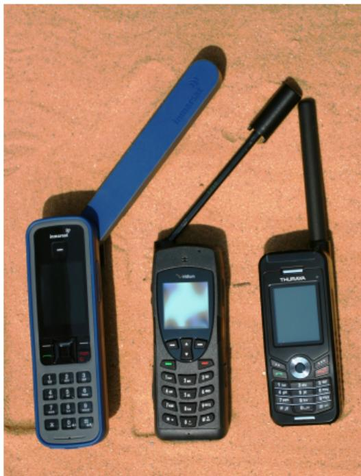
**Abb. 5:** Typische Endgeräte für LEO Satelliten: IsatPhone, Iridium, Thuraya. Man beachte die ausgeprägten Antennen. Die Authentisierung beim Betreiber und die Abrechnung laufen, wie bei 3G, 4G und 5G auch, über SIM-Karten.
