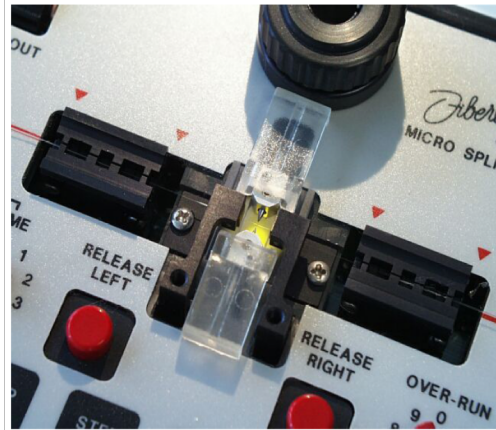
Abb. 12: Schweißgerät für Lichtwellenleiter. Beachte die seitlichen Einführungen für die optischen Leiter und die Metallspitzen zur Ausbildung des Lichtbogens.
