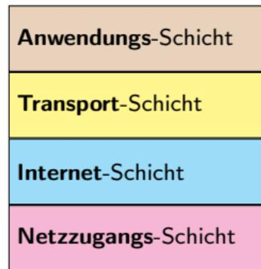
**Abb. 22:** Die gebräuchlichste Form des Architekturmodells ist diese 4-schichtige Internet-Architektur. Sie kann nur teilweise mit dem ISO-OSI Ansatz in Verbindung gebracht werden. Auch die Zuordnung von Numerierungen wird damit gelegentlich schwierig.
