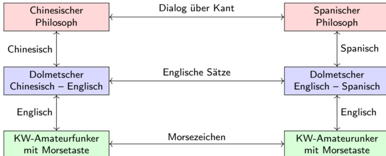
**Abb. 3:** Beispiel-Architektur zum Schichtenmodell
