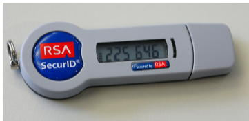
Abb. 4: Separater OTP-Generator und Smartphone-basierter OTP-Generator. ©
